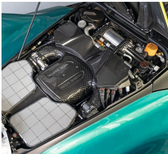
Le V12 atmosphérique de 6,5 l provient de Cosworth, la batterie hybride de Rimac et la boîte de vitesses de Ricardo.
