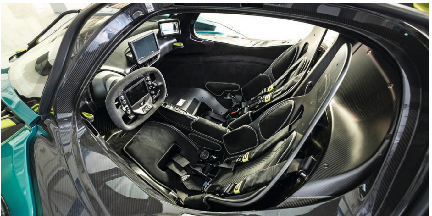
Les sièges baquets en carbone dans la monocoque en fibre de carbone ne pèsent que 8 kg.
